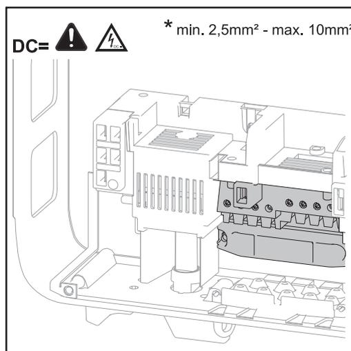
max. Kabelquerschnitt pro DC Kabel: 16 mm<sup>2</sup>
