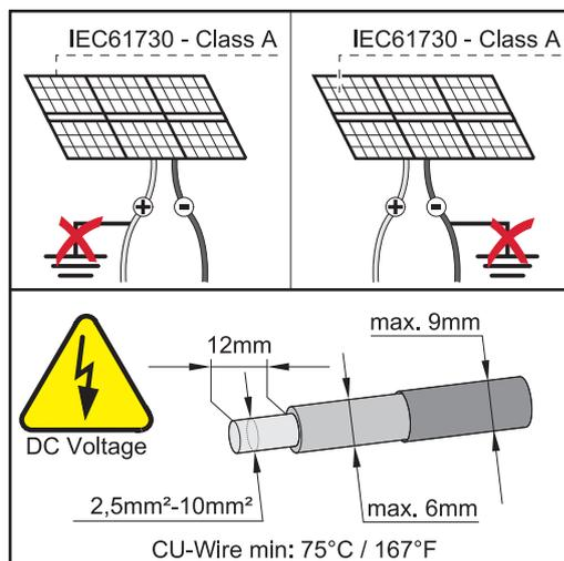
**Hinweis!** Die am Wechselrichter angeschlossenen Solarmodule müssen die Norm IEC 61730 Class A erfüllen.
