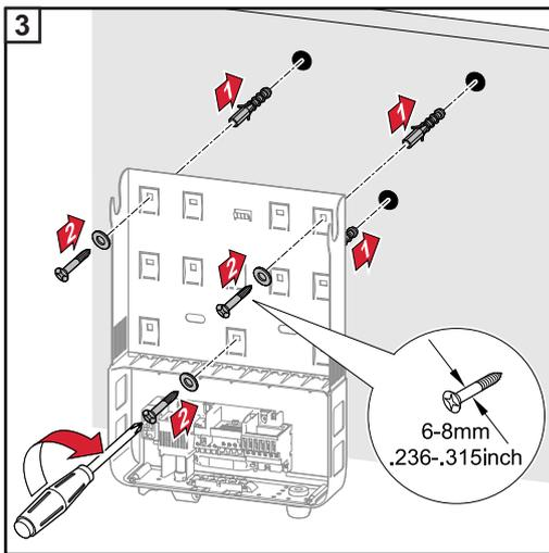
**Hinweis!** Bei der Montage der Montagehalterung an der Wand darauf achten, dass die Montagehalterung nicht verzogen oder deformiert wird.
