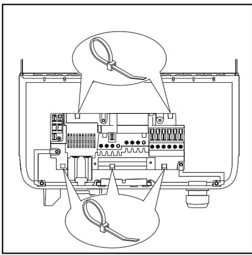
Sollen überlange AC- oder DC-Kabel in Kabelschlaufen im Anschlussbereich verlegt werden, die Kabel an den dafür vorgesehenen Ösen auf der Ober- und Unterseite des Anschlussblocks mittels Kabelbinder fixieren.
