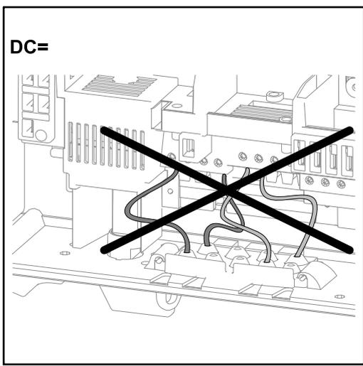
Werden DC-Kabel über die Welle des DC-Hauptschalters oder quer über den DC-Hauptschalter Anschlussblock verlegt, könnten diese beim Einschwenken des Wechselrichters beschädigt werden oder der Wechselrichter lässt sich nicht einschwenken.
