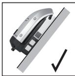
Der Wechselrichter ist für die Montage auf einer schrägen Fläche geeignet.
