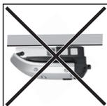
Den Wechselrichter nicht an der Decke montieren.
