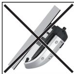
Den Wechselrichter nicht überhängend mit den Anschlüssen nach oben montieren.
