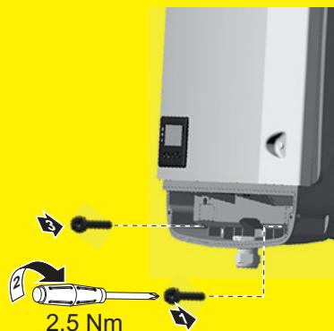
Az invertort minden csavarozza rögzítőcsavarokkal, a kezelési útmutatóban megadott nyomatékkal a falitartóhoz.
