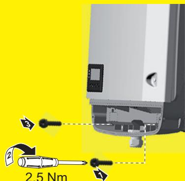
Fissare bene l'inverter al supporto di montaggio con le viti di fissaggio alla coppia indicata nelle istruzioni per l'uso.
