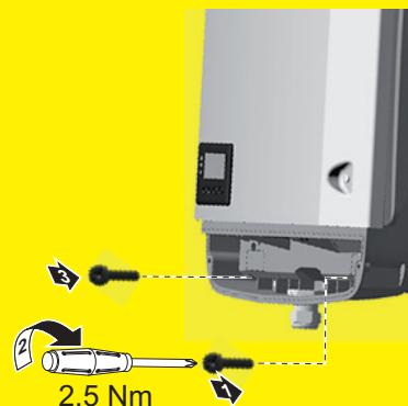
Střídač vždy pevně přišroubujte k montážní konzole pomocí fixačních šroubů a utahovacím momentem uvedeným v návodu k obsluze.
