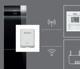
Funkmodul MX300: Verbindung zur Funk-Fernbedienung und dem Internet
