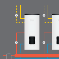
Alternativ Regelung erster/ zweiter Warmwasserspeicher
