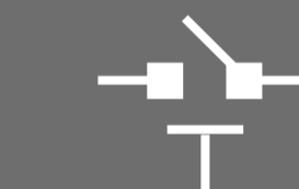
Wandgeräte: zweites Gas-Magnetventil
