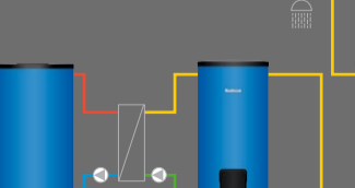
Umladesystem mit Vorwärmespeicher, „SAT-VWS“ (mit Modul SM200 Adr. 8)
