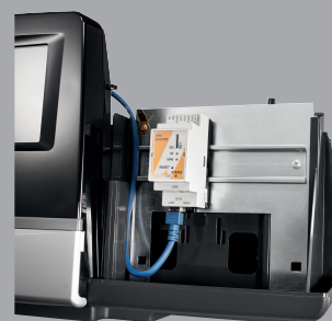
Digitales Regelgerät Logamatic 5000 mit dem IP-Gateway auf der Hutschiene
